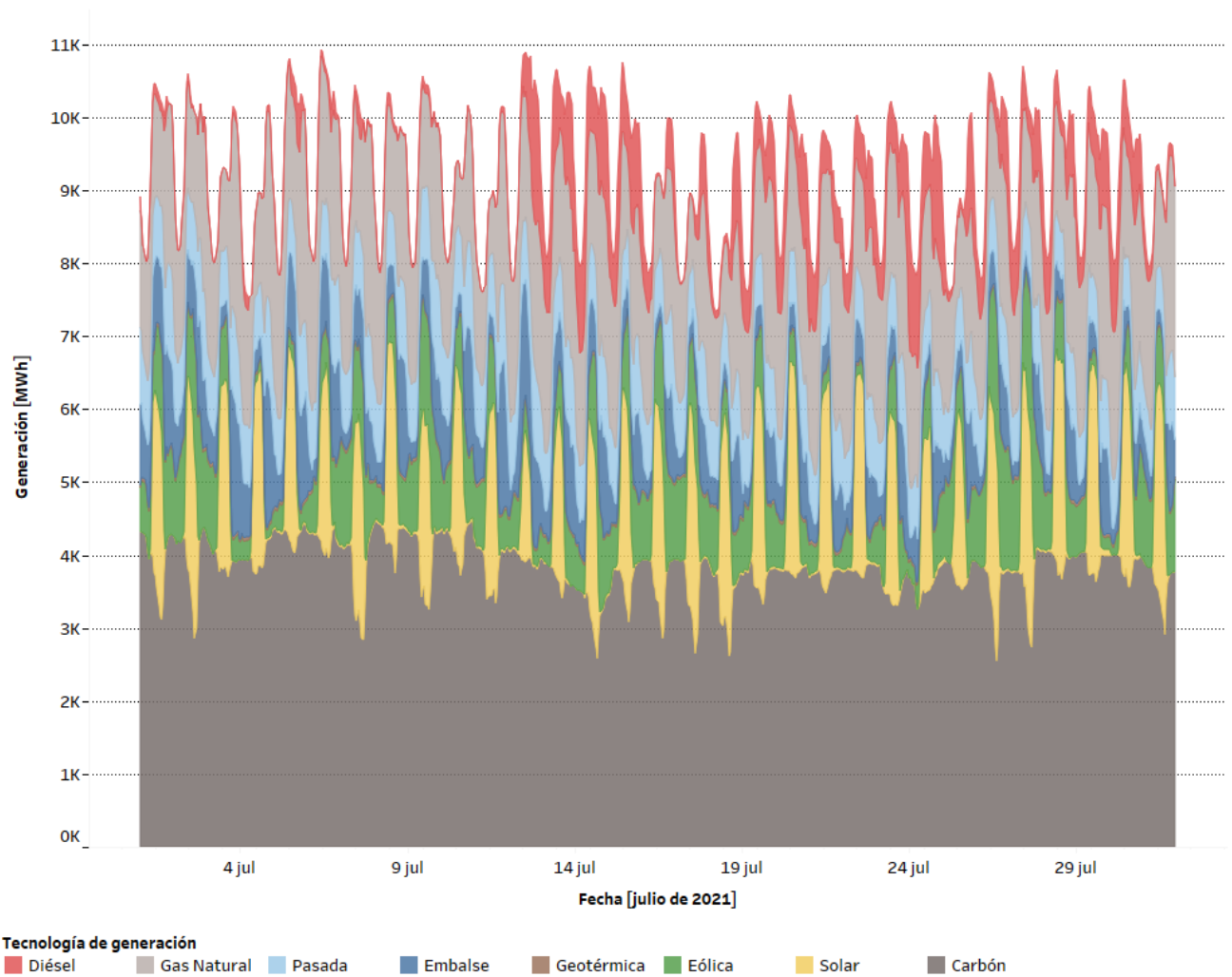
Figura 4.8: Operación real del sistema eléctrico por tecnología, para el mes de julio del año 2021.
